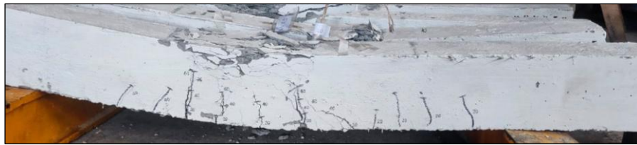
Figura 60 - Exemplo da metodologia utilizada para marcar as fissuras para viga VFAV1.0
