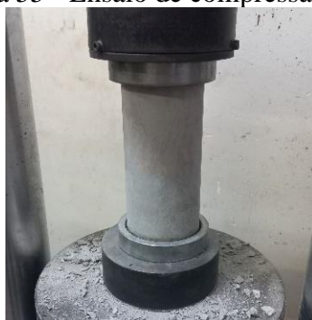
Figura 55 - Ensaio de compressão axial
