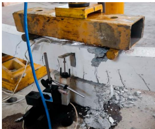
Figura 88 - Processo de ruptura da viga VFOV1.0
