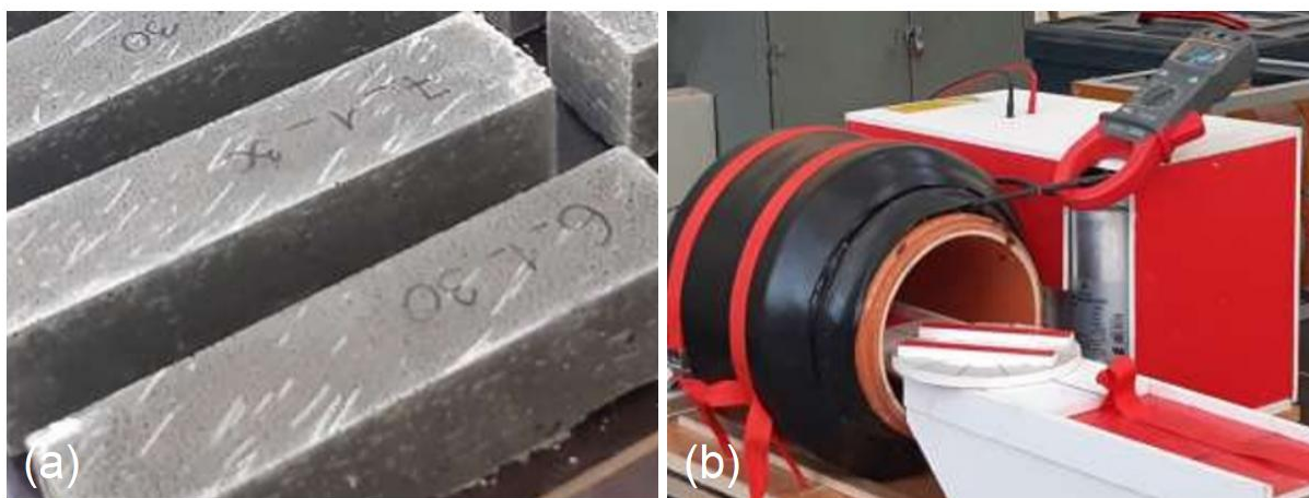
Figura 35 - (a) Corpos de prova e (b) processo de orientação das fibras
