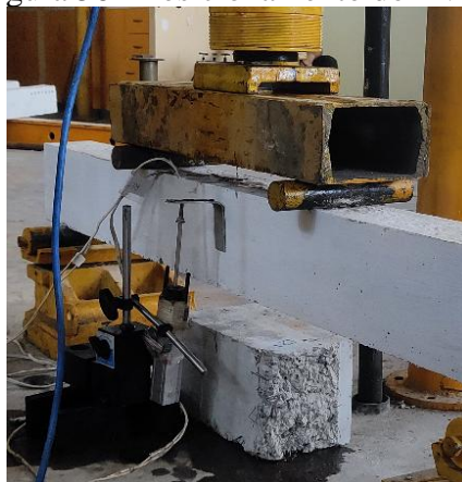
Figura 56 - Posicionamento do LVDT
