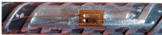
Figura 58 - Posicionamento dos Extensômetros no aço
