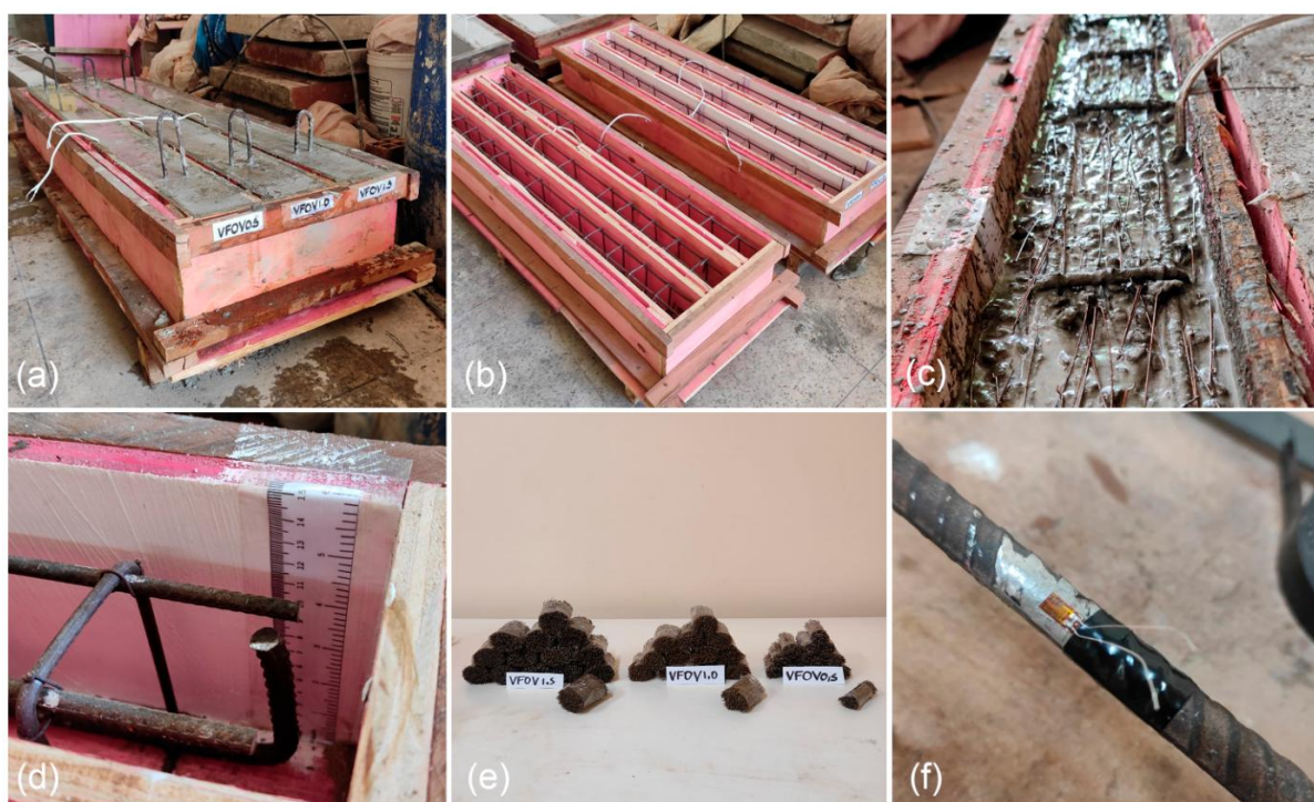
Figura 54 - (a) vigas concretadas; (b) armaduras das vigas; (c) concretagem das vigas alinhadas; (d) Escala das camadas; (e) Separação e organização das fibras; (f) extensômetros
